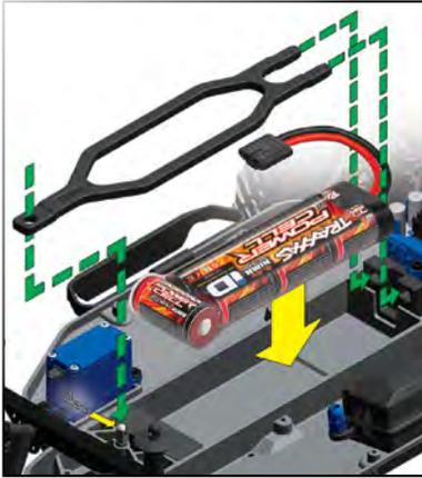
Setzen Sie die Batterie mit den Kabeln in Richtung der Rückseite des Modells ein. Setzen Sie die Laschen des Batterie-Niederhalters in die Schlitzlöcher auf der Rückseite der Halterung und setzen Sie anschließend den Batterie-Niederhalter über der Abtrennung ein. Sichern Sie den Batterie-Niederhalter mit einem Karosserie-Clip im Loch der Abtrennung. Schließen Sie den Batterie-Pack noch nicht an.
