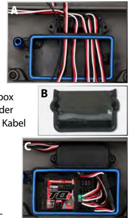
**Hinweis: Für beste Performance empfehlen wir, diesen Empfänger mit derselben Ausrichtung zu installieren, mit der auch der Original-Empfänger installiert war wie gezeigt.**
