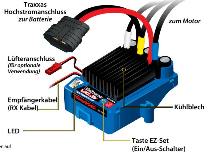
**Elektronischer Geschwindigkeitsregler/ Motor Elektrisches Diagramm**
