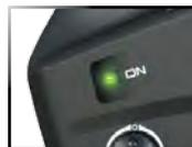
Wenn die Status-LED rot blinkt, sind eventuell die Batterien des Senders schwach, entladen oder nicht richtig installiert. Ersetzen Sie sie mit neuen oder frisch geladenen Batterien. Die Anzeigelampe zeigt nicht den Ladezustand der im Modell installierten Batterie an. Mehr Informationen über Sender, Statusanzeige und LED-Signale finden Sie auf Seite 29 im Abschnitt Fehlerbehebung.
